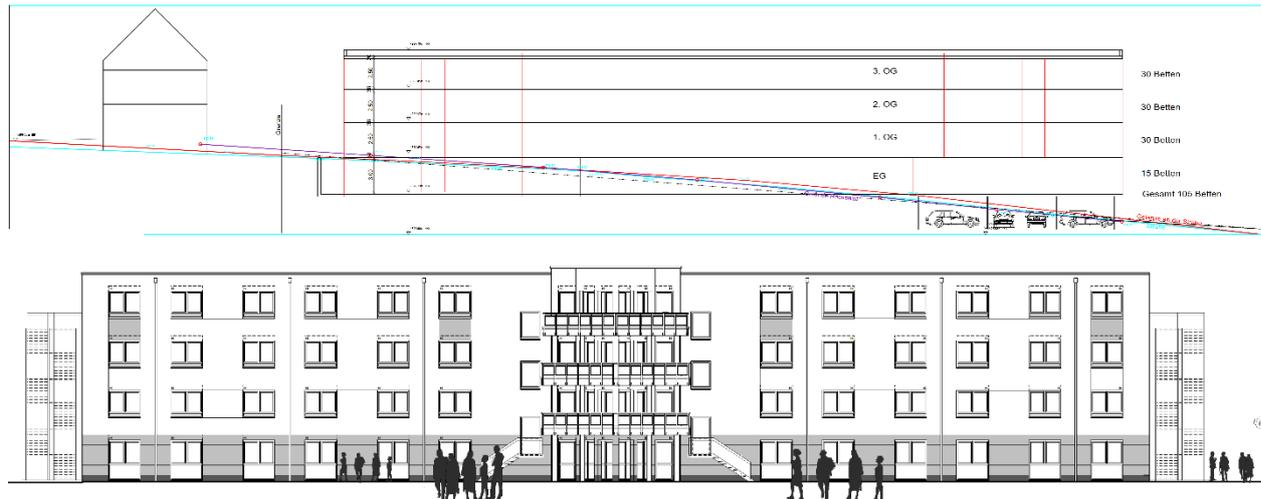
**Abbildung 10: Schnitt durch den geplanten Gebäudekörper von Nord nach Süd sowie Fassadenansicht Ostseite (unmaßstäblich)<sup>13</sup>**
