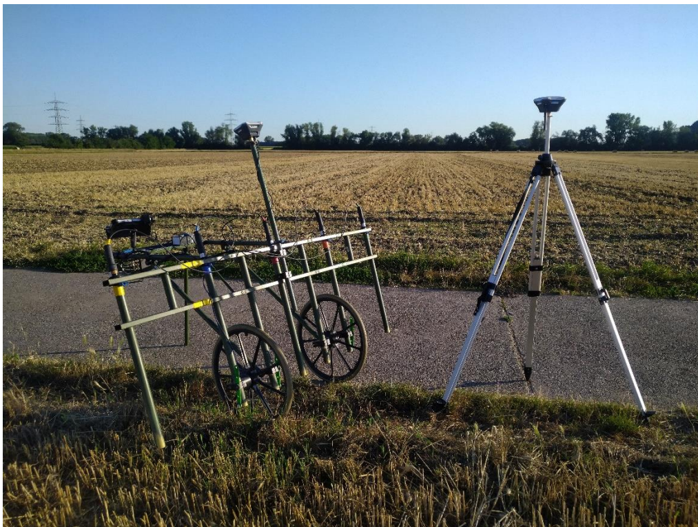
Abbildung 2 Die Ausrüstung: Messwagen (links) und GPS-Basisstation (rechts).
